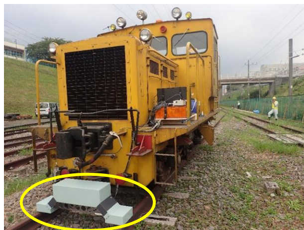
図10 リアルタイム軌道検測システム（プロトタイプ）
