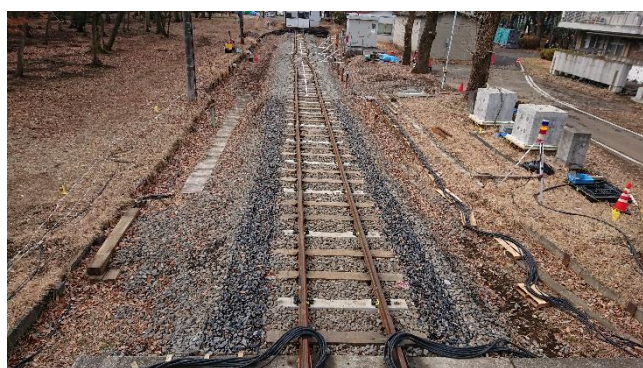
図3 実物大軌道模型座屈試験
