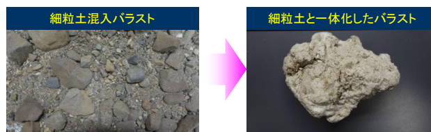
図4 細粒土混入バラストの造粒化
