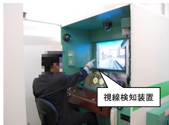
図1 視線検知装置付き運転シミュレータ
