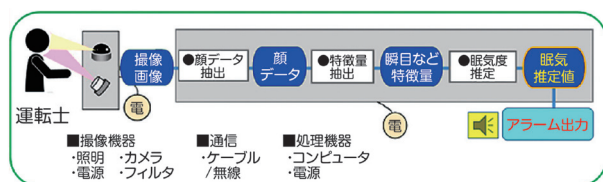
図8 眠気度推定システムの基本構成
