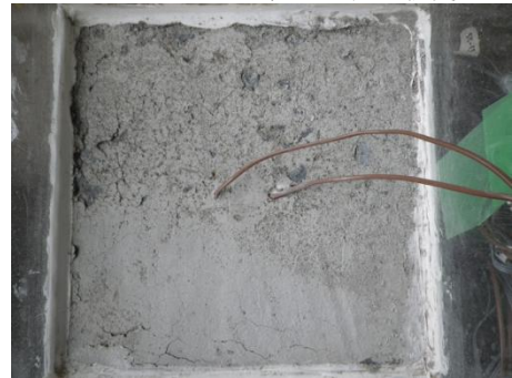
(4) 空気量 1.5%上面 (W/C=55%, 気中養生)
