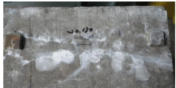
(3) 空気量 1.5%下面 (W/C=55%, 封緘養生)
