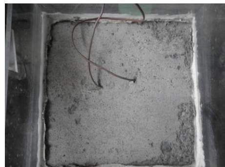
(5) 空気量 5%上面 (W/C=55%, 気中養生)
