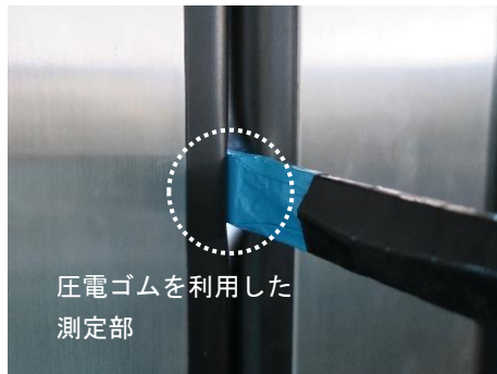
図5 挟み込み力を測定するセンサ
