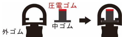
図3 分割した戸先ゴムの断面
