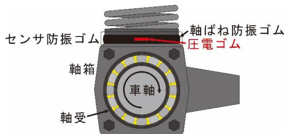
図 10 センサ防振ゴムによる軸受の損傷検知
