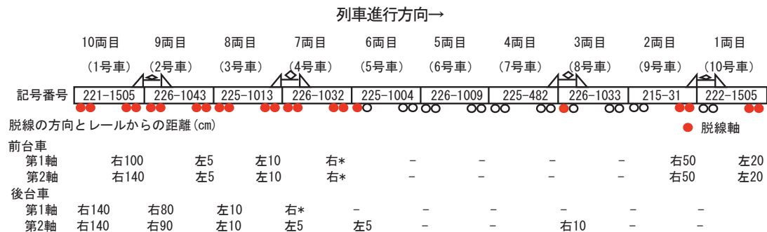
図2.2 列車の脱線状況 3) ※図中の第1軸、第2軸は、各々前軸、後軸を示す。
