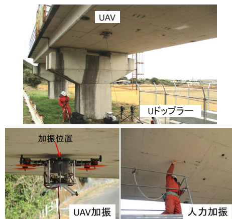
図 15 弾性波の測定・加振状況
