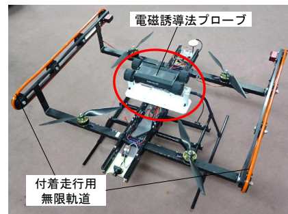
図4 鉄筋探査装置を搭載した付着走行用 UAV
