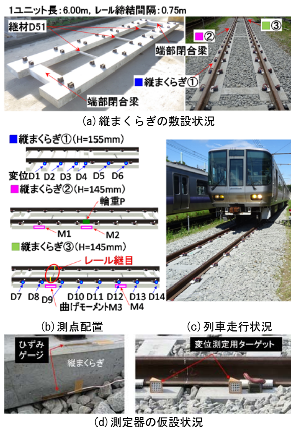
図 14 縦まくらぎの列車走行試験の概要
