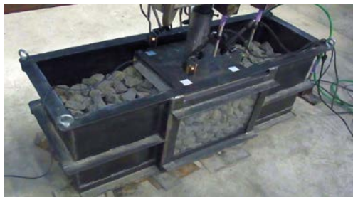
図5 土槽内に敷設したバラスト層
