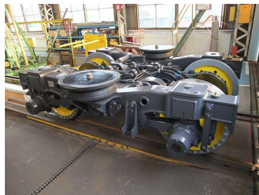
図1 輪重減少抑制台車の外観
