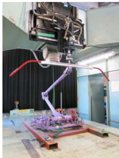
図9 実機パンタグラフを用いた HS 試験
