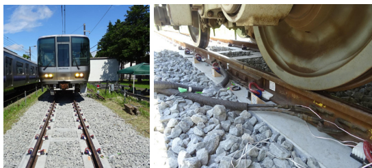
図4 低廉な縦まくらぎと所内試験状況
