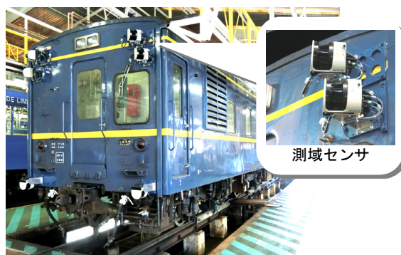
図 5 供試車両外観と測域センサの設置状況
