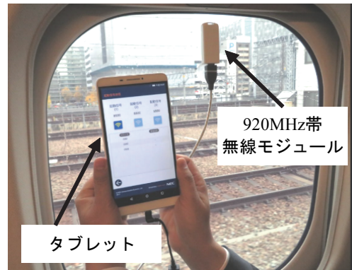
図13 車載装置設置状況
