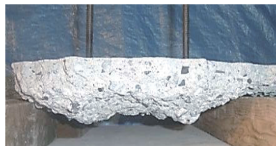
図8 アンカー間隔が近接する場合の破壊状況
