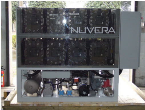
図2 100kW 級の固体高分子形燃料電池の外観
