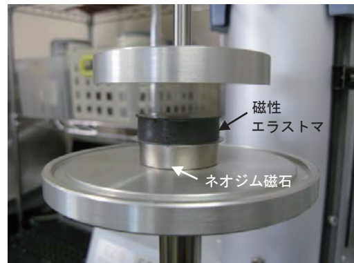
図 6 圧縮試験の様子
