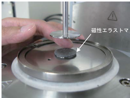
(a) 磁性エラストマ試験片
