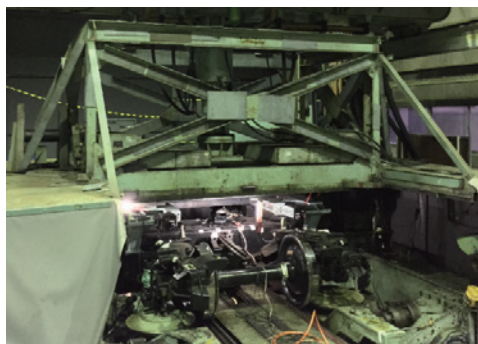
図4 台上回転試験の実施状況
