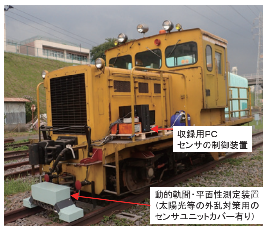
図9 動的軌間測定試験の様子
