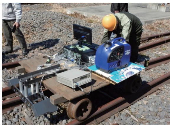
図5 歩行速度での軌間測定試験の様子
