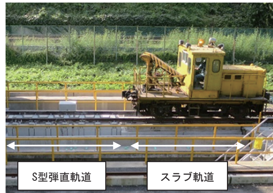
図 15 モーターカー走行試験の状況
