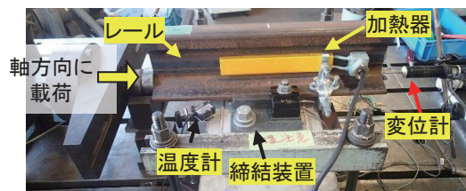
図15 温度を管理したふく進抵抗試験の概要
