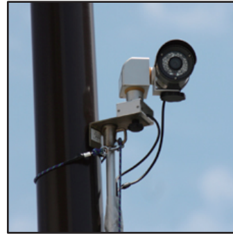
図1 高所撮影システム（株式会社道路計画 HP より）
