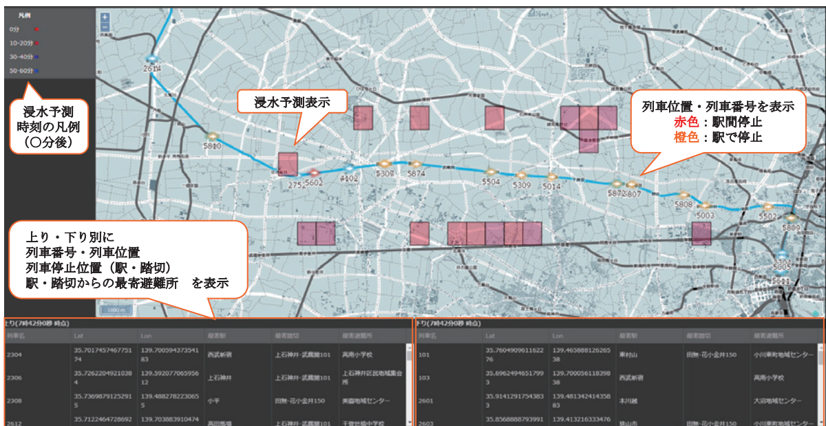
図7 浸水向け列車停止位置決定および避難場所決定支援システムのプロトタイプ画面例
