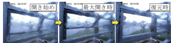
図14 自然風による遮音板の開閉
