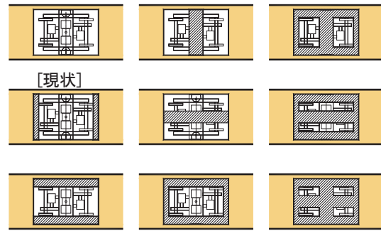
図3 台車底面カバー(網掛け部:カバー領域)
