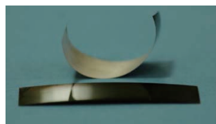
図 11 Y 系超電導線材の剥離事例
