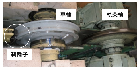
図2 ブレーキ性能試験機粘着測定ユニットの構成
