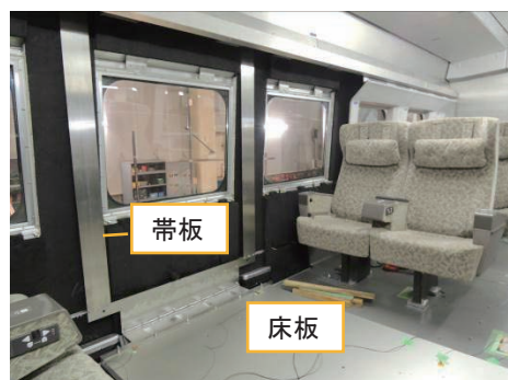
(a) 帯板吊り
