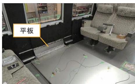
(c) 平板吊り
