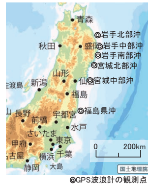
図3 2次元計算(外洋伝播)の妥当性確認に用いたGPS波浪計の観測点分布
