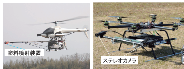
(a) 反射ターゲット形成装置 (b) 空撮測量用 UAV
