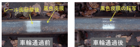
図4 列車走行によるレール面の黒色皮膜の転写
