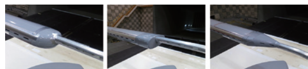
図12 舟体端部の改良形状
