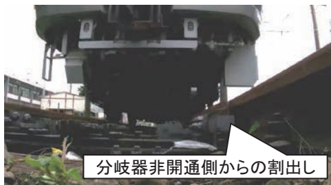
図8 割出し転換試験の状況
