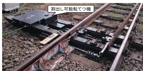
図5 割出し可能転てつ機(試作機)
