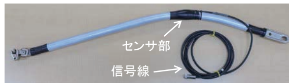
図2 センサ付曲線引金具
