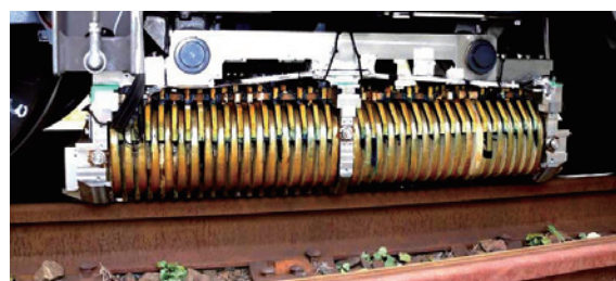
図6 所内走行試験用電機子 (防護カバーを取り外した状態)
