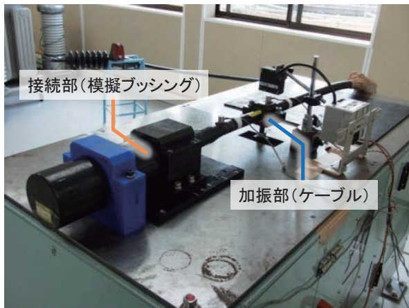
図4 ケーブル接統部動的評価試験装置の外観
