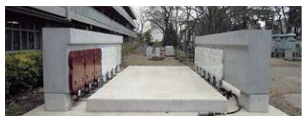
図 3 PLG コイルを設置した実機大模擬ガイドウェイ
