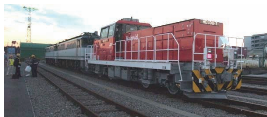
図 15 散水空転試験風景
