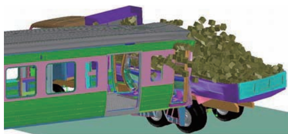
図7 車体の衝突解析例(54 km/h, 衝突後250ms経過)
