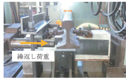
図13 疲労試験の状況
