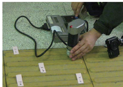
b) 反射率計を用いた測定風景(写真はCR-200)
