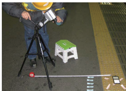
a) 輝度計を用いた測定風景(写真はCS-100A)
