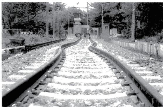
図1 軌道座屈試験による座屈再現状況 2)
