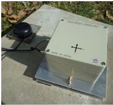
(b) 計測部(左：GPSアンテナ，右：サーボ式加速度計)
