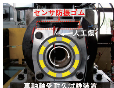
図 17 損傷検知性能評価試験状況
