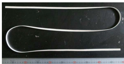
図9 戸先ゴム内部の圧電ゴムの外観
