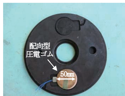
図 16 防振ゴム内部の圧電ゴム
