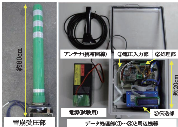
図11 雪崩検知装置（試作器）
