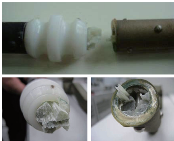
図 1 循環電流防止形曲線引金具における FRP の脆性破壊例
