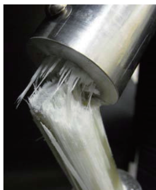
図8 比較品の破壊試験後の状態
