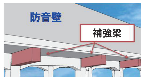
図2 開発した補強工法のイメージ
