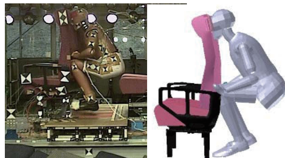
ダミー人形による衝撃試験 有限要素解析モデル
