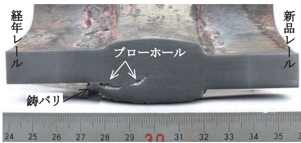
図7 底部側面を研削して現出したブローホールの溶接欠陥（底部側面から10mm内部）
