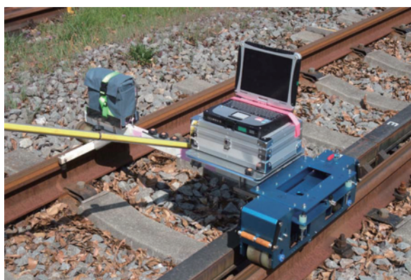
図2 レール凹凸連続測定装置（試作2号機）の外観
